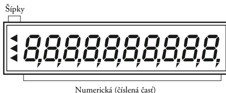
Obrázek 2.5 Rozdělení segmentového LCD displeje.
