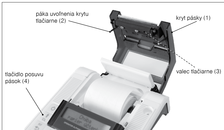
Obrázok 2.6 – Zavedenie papierovej termo pásky do tlačiarne pokladnice
