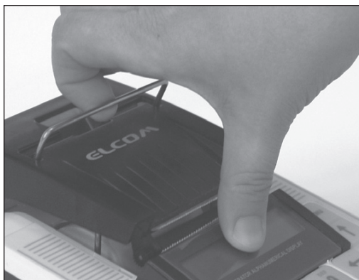
Obrázek 2.7 - Otevírání krytu pásky
