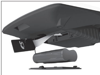
Obrázok 2.8 – Zavedenie SD karty do pokladnice
