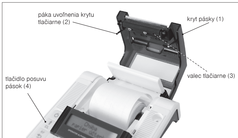
Obrázok 2.6 – Zavedenie papierovej termo pásky do tlačiarne pokladnice
