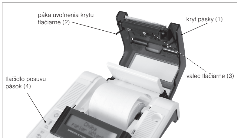
Obrázok 2.6 – Zavedenie papierovej termo pásky do tlačiarne pokladnice
