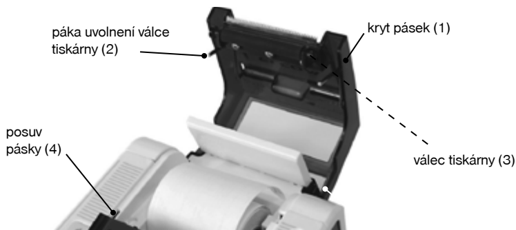
Obrázek 2.6 – Zavedení papírové pásky do tiskárny
